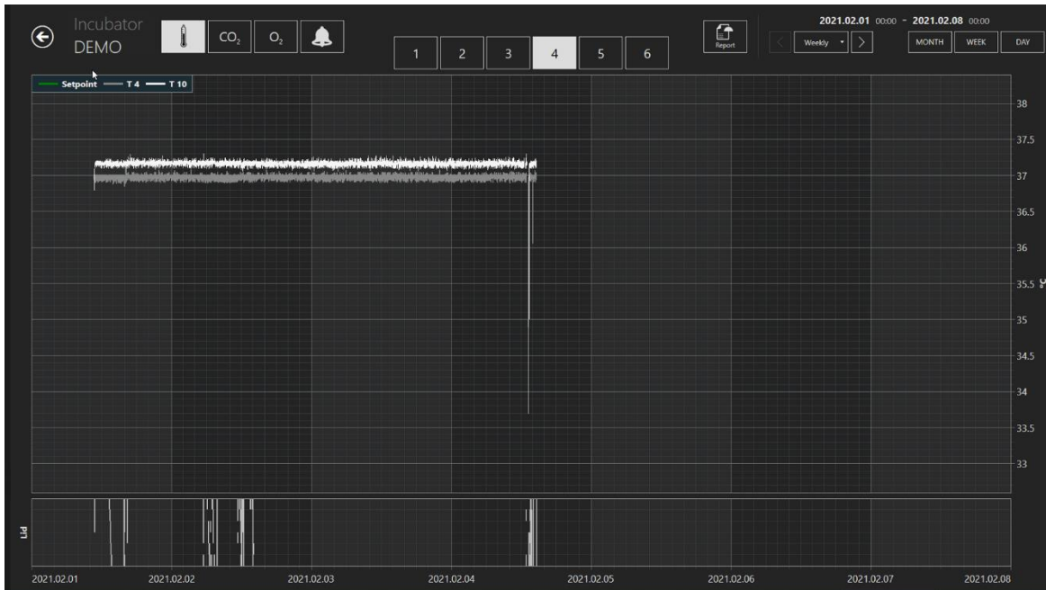
Figura 7.123 Vista del registro de datos de temperatura de incubación de la incubadora "DEMO"
