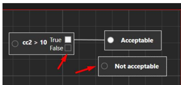
Figura 7.150 Nodo condicional con nodo de resultado "Acceptable [Aceptable]" conectado
